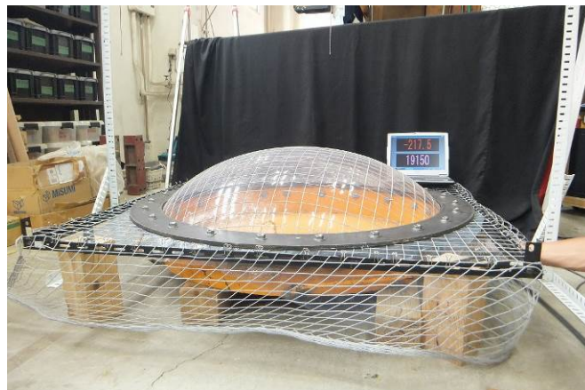
写真-4 横浜国立大学での引張剛性試験
