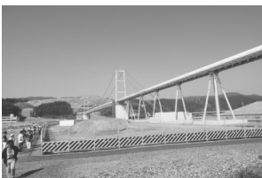
橋ではない、土砂を運ぶベルトコンベア
