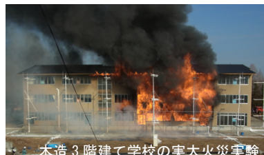
木造3階建て学校の実大火災実験
