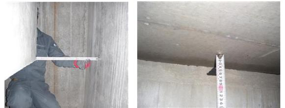
写真 12 水平変位に変化はないか 写真 13 鉛直変位に変化はないか
