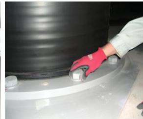
写真1 ゴムに変質・損傷はないか
